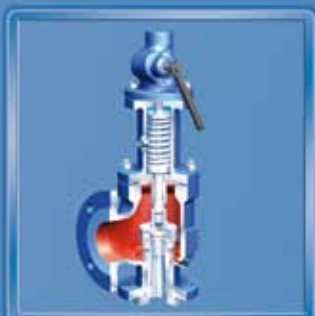
SAFE-FN ANSI gemäß API526 geschlossene Anlüftung
